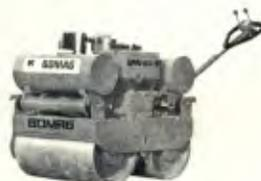
Rolo Compactador Tandem Vibratório Bomag Mod. B W65S ● Autopropelido ● Motor Hatz Diesel de 5HP ● Largura de Compactação: 0,65m ● Peso estático: 560Kg ● Impacto de Compactação: 2.000Kg ● 2 velocidades de tração a frente e ré ● Frequência de vibrações 3.500V.P.M.
