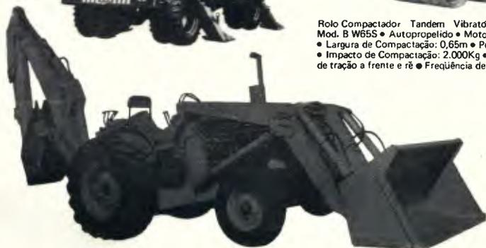
Unidade Industrial Ford 4500/755 — Motor Diesel de 62,3 HP a 1.800 rpm ● Conversor de torque ● Reversão automática de marchas e direção hidráulica ● Capacidade da carregadeira: 1 jarda cúbica rasa (2.040 kg de levante) ● Retroescavadeira hidráulica com caçamba de 1/2 jarda cúbica de capacidade ● Profundidade de escavação: 4,61 m.
