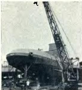
HP, que apresenta um comprimento total de 30,35 m, uma atração estática (**bollard-pull**) de 50 t, com dois motores de 1920 HP e velocidade de serviço de 11 nós.
