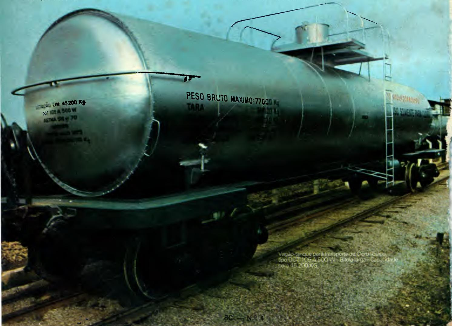
Vagão-tanque para transporte de Cloro Líquido
