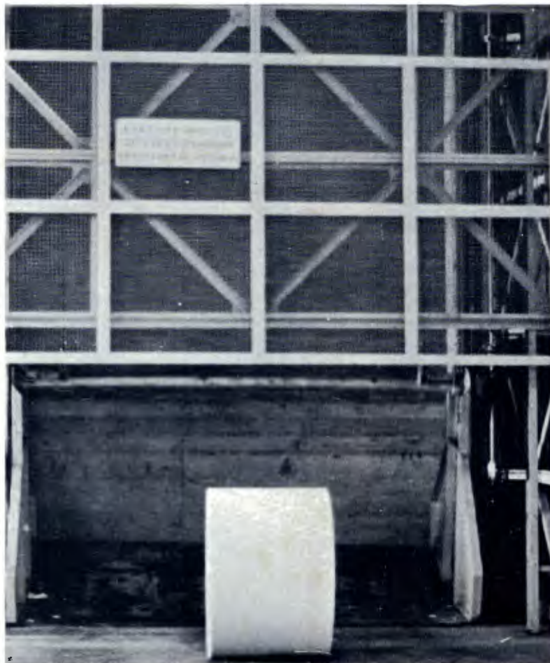
O elevador chega, a bobina ganha impulso e sai sozinha da gôndola.
