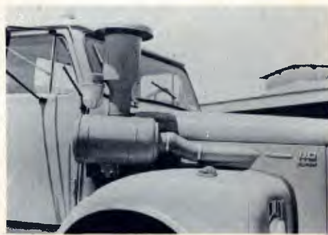
Scania: o mais potente dos nacionais, pode tração até 70 t, com auxílio da turboalimentação do motor.
