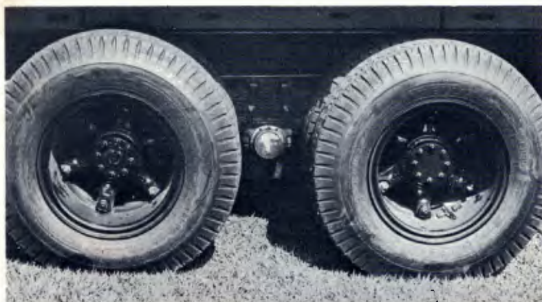
Terceiro eixo: mais carga e menos velocidade. Diferencial é básico.
