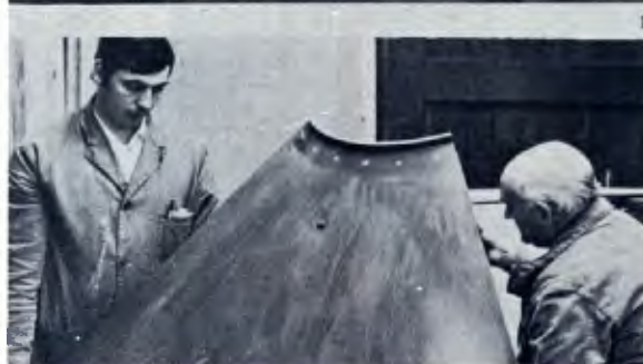
Lanterna de farol: fabricada em plástico reforçado.
