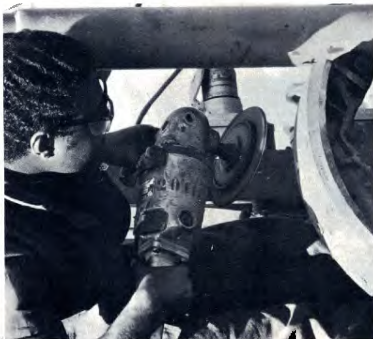
Em cima: mecânico trabalha lona de freio. Direita: lanternagem, solda e pintura numa única seção.
