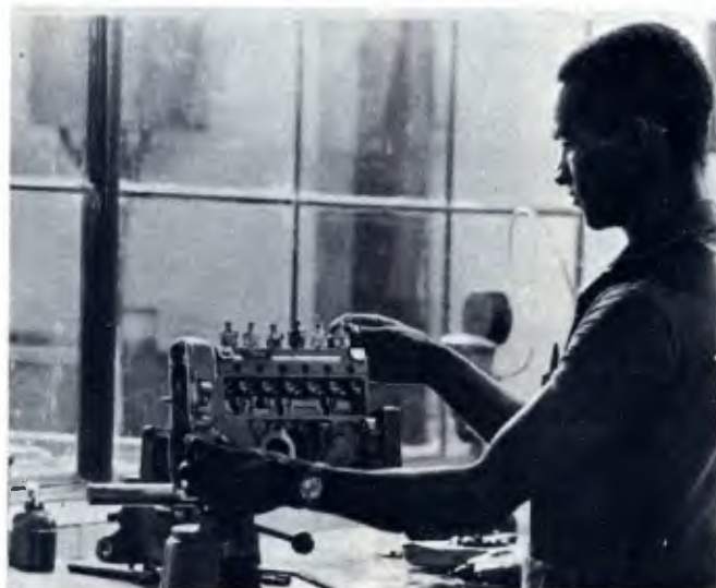
Seção de injetoras (em cima): o funcionamento de um distribuidor é testado. Dinamômetro (direita): verifica a qualidade dos serviços executados durante a reforma dos motores.
