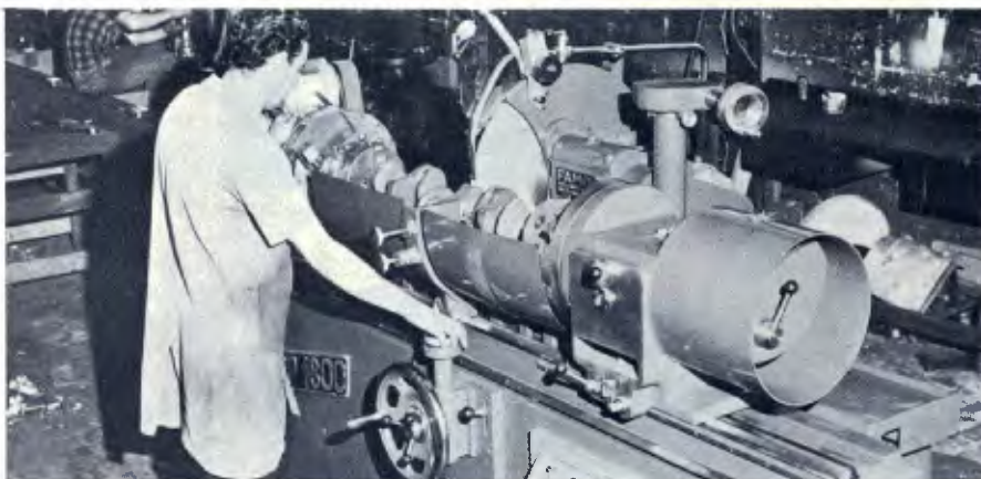
Retificadora: base de ferro fundido com guias para mesas e caixas.
