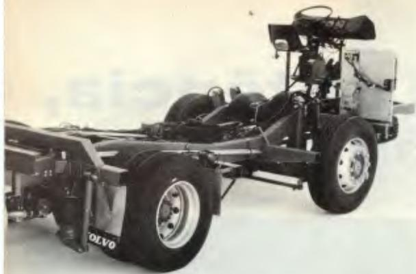
**O novo chassi incorpora uma série de inovações: motor traseiro, opção para tração 6x2, câmbio com monitor para programar marchas e suspensão a ar**
