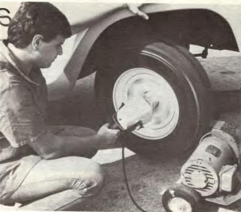
Equipamento portátil facilita o balanceamento das rodas
