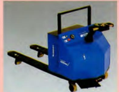
**PCE: paletes padronizados** aciona tração e elevação elétricas, em três velocidades à frente e à ré. Permite que o empilhador fique em pé no pedestal.
