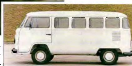
parte mecânica. O motor é o mesmo 1.6 refrigerado a ar, com opções para álcool e gasolina. O motor não muda para beneficiar-se
