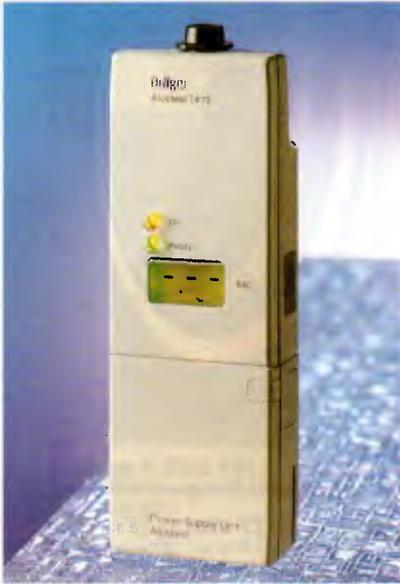
Antes da partida do veículo, o aparelho eletrônico solicita no *display* o sopro do motorista. Não sendo atendido, ou quando atendido, mas registrando teores alcóolicos não admissíveis, o Dräger Interlock bloqueia a ignição. O mesmo ocorre diante de medições duvidosas, como o sopro de quem acabou de vomitar após beber.
