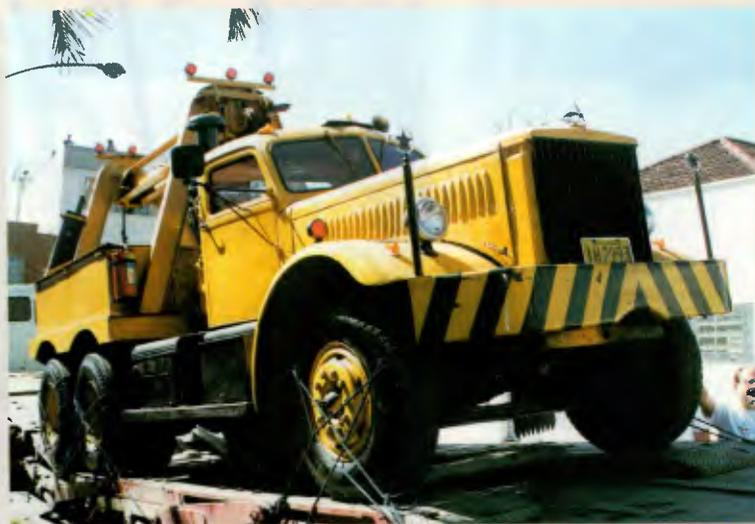
comprou um guincho feito segundo os conceitos militares da Segunda Guerra, um veículo com capacidade para transportar tanques. Originalmente este Diamond T tinha motor Hércules, posteriormente substituído por um diesel GM
