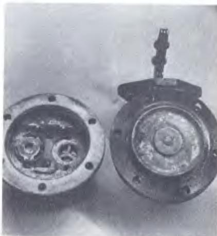
A bóia do tanque engripa por efeito da corrosão. A bomba de alimentação também sofre degeneração
