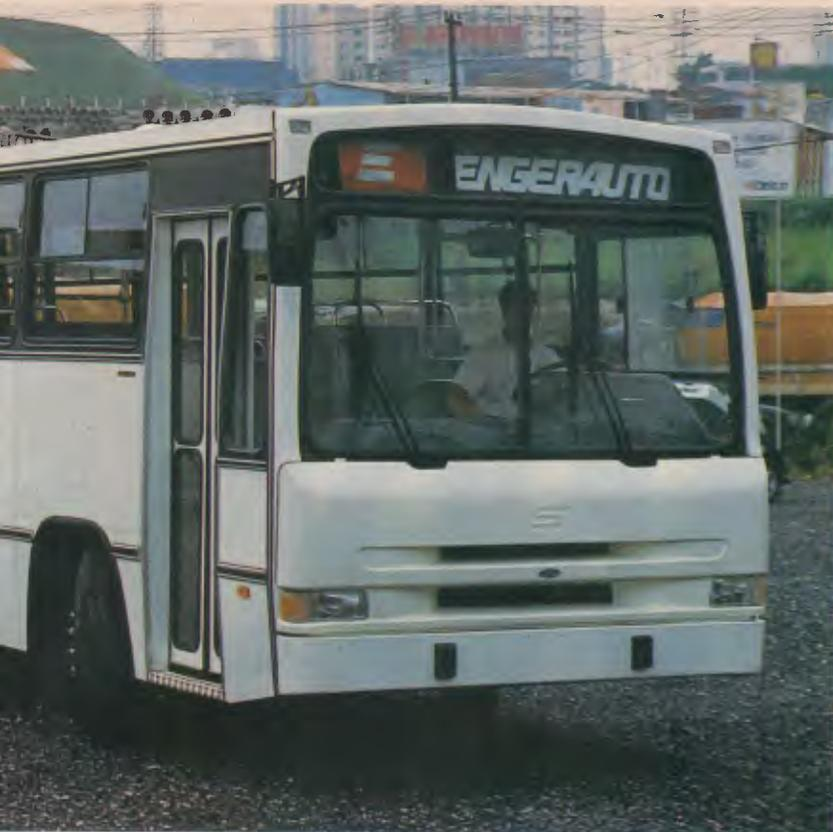
**Modificações no Transport abrem espaços maiores para os vidros, diminuem uma aleta no painel frontal e reforçam estrutura e acabamento, tanto interno como externo**
