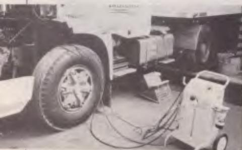
A máquina limpa bicos com motor no cofre
