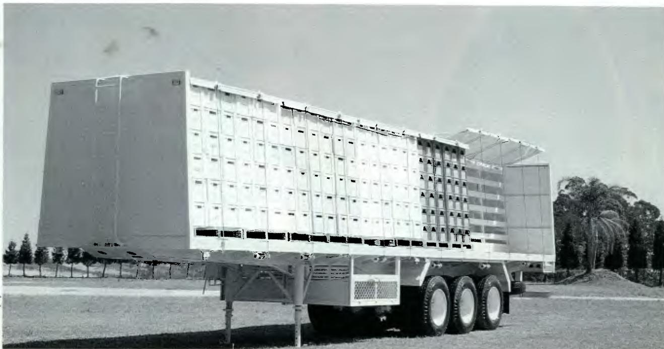
Concebido para cargas paletizadas, o semi-reboque Asa Delta reduz em até três horas o tempo de amarração
