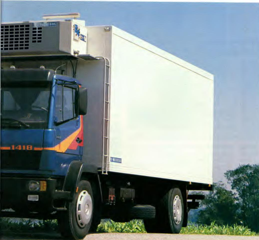
Utilizando motores de 140 e 180 HP, os modelos FPN têm versões para 12, 14 e 17 t
