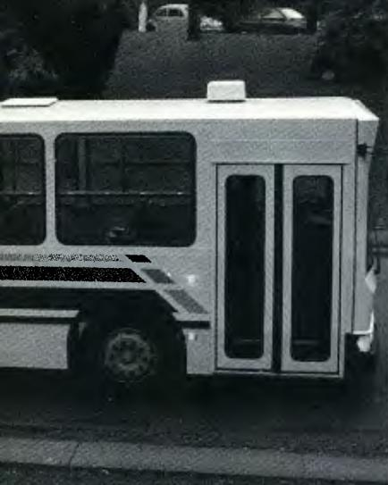
A nova versão incorpora itens como: esticador único, baterias próximas ao motor, painel elétrico na cabina e novo mecanismo de acionamento das portas
