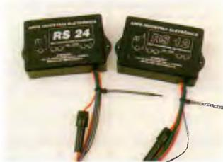
Recém-lançado no mercado, o modelo RS, da Arpe, relé sequenciador de iluminação, de 12 V e 24 V, permite ao veículo utilizar um número maior de lâmpadas, melhorando a sua visualização.
