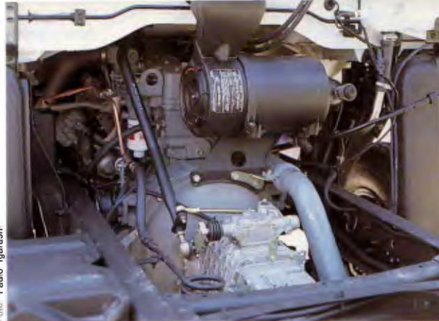
O motor Cummins 4BT com turbo-aftercooler dá ao Cargo 814 a maior potência na categoria dos leves
