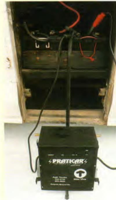
Testado em concessionárias e em oficinas credenciadas do Senai, o aparelho Praticar, com 100 A e 12 V, se carrega assim que é ligado a uma tomada de 220 V. Após carregado, sem estar plugado à tomada, aciona mais de trinta partidas.
