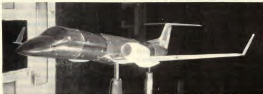
**O túnel analisa o impacto do vento em todas as partes dos aviões em escala até 1:6**
