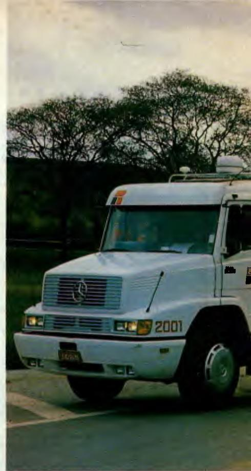
A composição da Real compreende um cavalo mecânico MBB 1935, cabina tradicional, e dois semi-reboques unidos por um *dolly* (ver Quadro). As carretas têm 6,5 m cada uma, e o comprimento total da unidade é de 19,8 m. Pinheiro ressalta que o ideal é a utilização de cavalo mecânico de cabina avançada, graças à qual se aumenta o comprimento das carretas.
