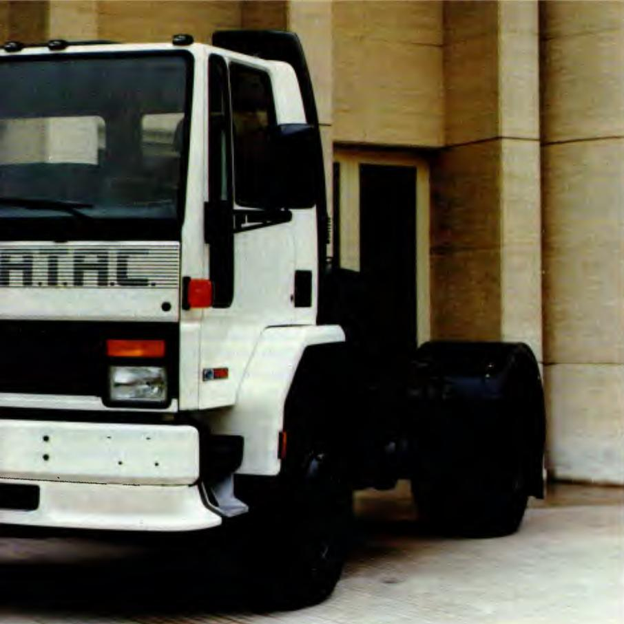
O último filhote da família Cargo é o cavalinho 4030, para tracionar semi-reboque de três eixos ou dois reboques; o próximo será mais pesado
