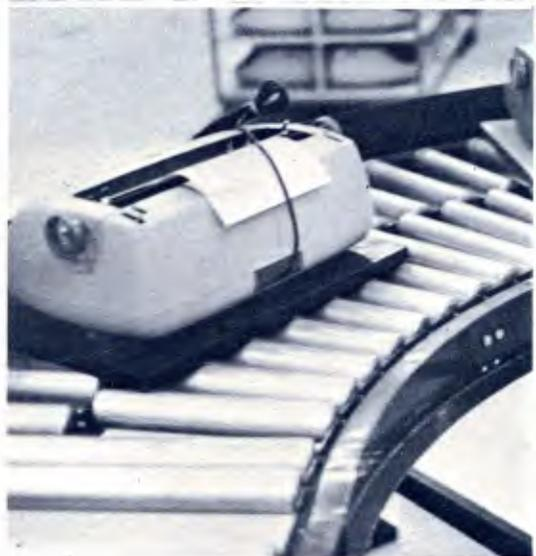
Na extremidade da linha de espera, a curva de 90° inicia a passagem da máquina para a linha de testes onde funcionam duas bancadas.
