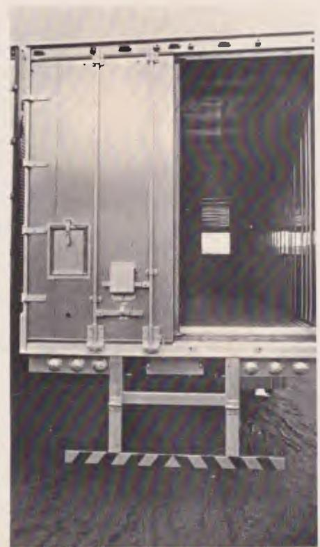
O alumínio do revestimento começa a ser substituído pela fibra de vidro, cujo emprego só não é maior em virtude do alto custo. A preocupação econômica também leva o transportador a analisar rigorosamente cada carga, para saber se não está diante de um caso em que o semi-reboque é mais conveniente que o furgão.
