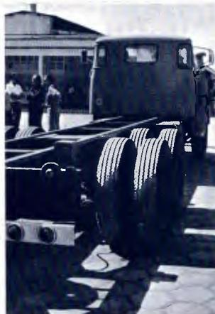
A redução traseira mais longa permitirá uma velocidade de até 74 km/h. Mas, optando-se por uma redução mais curta, essa velocidade poderá chegar a 96 km/h. A principal aplicação será como cavalo-mecânico, tracionando carretas de um ou dois eixos traseiros. Haverá três opções de distâncias entre eixos: 3,80, 4,20 e 5 m. A capacidade de carga bruta será de 15 t no caminhão simples, 22 na versão com terceiro eixo e até 30,5 no semi-reboque. O motor continua sendo o D-11 da linha convencional.
