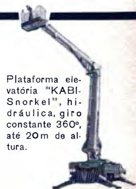
Plataforma elevatória "KABI-Snorkel", hidráulica, giro constante 360°, até 20m de altura.
