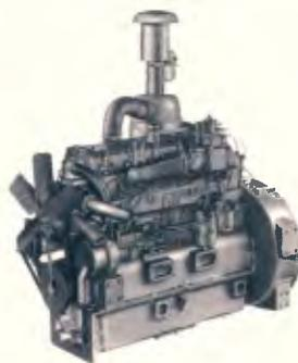
zer, fabricado sob licença da Wallace Murray, de Indianapolis, EUA. O motor tem 6 cilindros em linha, cilindrada de 5,84 l, compressão de 18:1. Torque máximo de 35,9 mkg a 1800 rpm e potência de 121,5 cv a 2400 rpm. Pêso: 610 kg. Para aplicações industriais.
