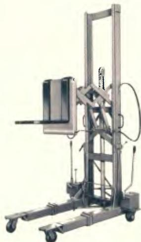
Empilhadeira manual de acionamento hidráulico, para 800 kg de carga, adaptada com plataforma especial para tecelagem. A rodagem dianteira é regulável, e os comandos de elevação da coluna e da plataforma são independentes. Alcance de 4 m.
