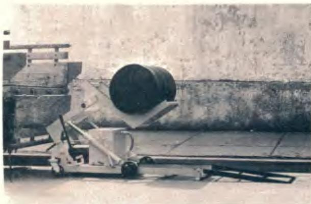
Dispositivo para carga e descarga de tambores em caminhões. Acionado por bomba hidráulica e motor elétrico de 1 HP. O braço que maneja os tambores é adaptável a diferentes alturas de carrocerias.
