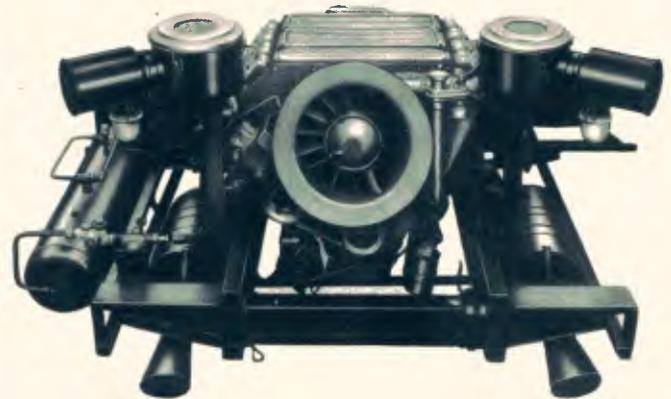
A Magirus-Deutz lançará no início de 1970 os chassis RL 413, tipo integral, e URL 413, de longarinas, com novo motor de 230 cv (DIN) a 2 650 rpm. Comprimento do chassi: 11,30 m; 6,00 m entre eixos, bitola traseira e dianteira de 2,14 m, 4 700 kg de peso e capacidade de 13 000 kg de carga. O diferencial terá re-
