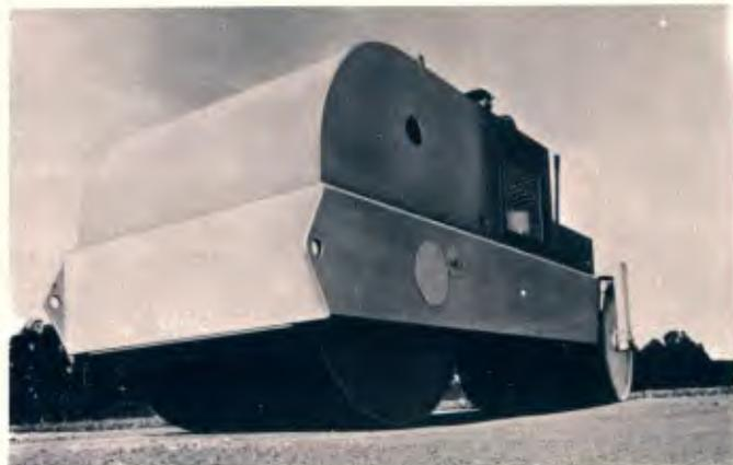
Mais dois equipamentos de compactação já estão sendo produzidos nas linhas de montagem da Tema Terra, em Campinas. O primeiro é o rôlo pé-de-carneiro autopropulsor SP-255, equipado com motor Perkins de 165 BHP a 2 500 rpm e 52,3 mkg de torque. A máquina tem dois tambores, de 1,53 x 1,53 m. Somente duas patas tocam o solo de cada vez. Equipado com direção hidráulica, o equipamento é fornecido com três diferentes tipos de patas, removíveis. Peso total do rôlo, com lastro: 16,5 t.
