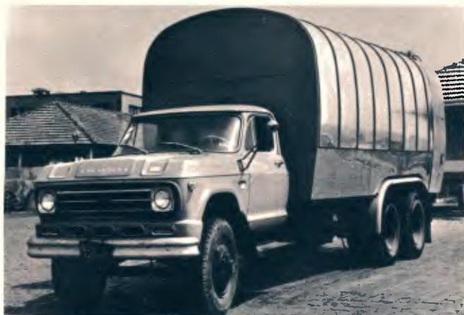
O coletor compactador de lixo "Kuka Piratininga", fabricado sob licença da Keller & Knappich, da Alemanha, aumentou sua capacidade de coleta, com a montagem sobre chassi com terceiro eixo. Pode coletar agora 30 m<sup>3</sup>, ou 10 t. A primeira unidade com
