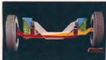
**EXCLUSIVA SUSPENSÃO "TWIN-I-BEAM"**—A suspensão dianteira "Twin-I-Beam" é a responsável por boa parte de tanto conforto do Ford F-100. "Twin-I-Beam" quer dizer eixos duplos em viga I. Como você vê, a Ford colocou um eixo a mais para fazer a suspensão independente. Claro que isso significa resistência em dobro. Para flexionar esses eixos, a Ford colocou molas helicoidais. E o resultado foi a combinação per-
