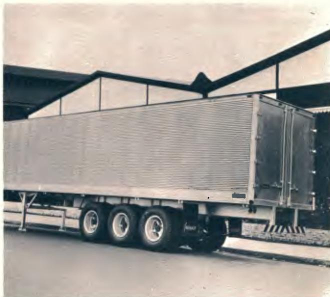
Com as primeiras unidades lançadas em setembro e adquiridas por uma indústria de laticínio, a Fruehauf introduziu em sua linha de fabricação o semi-reboque furgão isotérmico, modelo FB-F3-ISO-12,80-25-AL, de três eixos, rodagem de 22 polegadas (sem pneus). Sua capacidade é de 25 000 kg e o peso com pneus de 8 970 kg. Freios a ar, suporte para dois estepes, estrutura monobloco em alumínio com quadro de apoio
