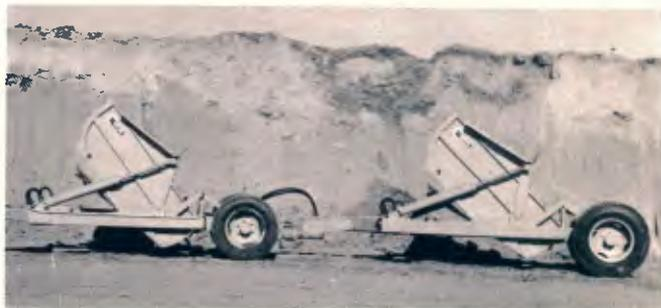
A Madal, de Caxias do Sul (RS), requereu patente e começou a produzir as raspadeiras (scrapers) em tandem modelo 30-30RT, com capacidade de 7,4 m<sup>3</sup>, para serem tracionadas por tratores de pneus de potência superior a 90 HP. O conjunto é operado por uma só pessoa, que, em jornada de dez horas, em 72 viagens na distância média de 600 m, remove e transpor-
