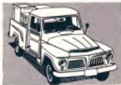
O Pick-up Jeep Ford é resistente e transporta fácil 750 kg de carga na sua caçamba. Tem 3 ou 4 marchas sincronizadas, com TRABAL (diferencial auto-blocante) e tração nas 4 rodas
