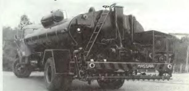
Para que o espargimento de asfalto seja uniforme e proporcional à velocidade, o sistema é integrado à caixa de câmbio.
