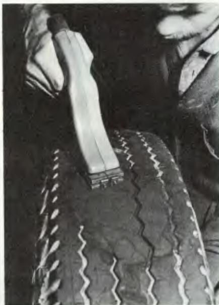
uma máquina injetora. Por dentro do pneu é aplicado um manchão. Por fora, isto é, na banda de rodagem, é realizado um enxerto e, depois, a ressulcagem do local reparado. Com isso, o pneu volta a trabalhar, normalmente.
