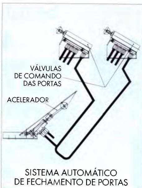
SISTEMA COMPOSTO DE DUAS VÁLVULAS DE ACIONAMENTO DE PORTA E UMA EMBUTIDA NO ACELERADOR.
