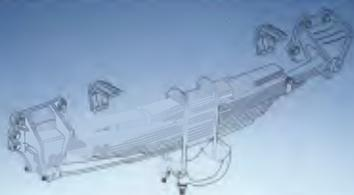
3. Na instalação do terceiro eixo, ainda perdia as molas, o suporte de molas e batentes, grampos de fixação e conjunto da barra estabilizadora.
