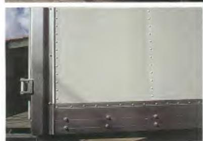
O novo baú de perfis de alumínio (foto central) valoriza a estética exterior, sem abrir mão de inovações estruturais nas colunas internas (no alto) e na tecnologia de encaixe e acabamento (ao lado)
