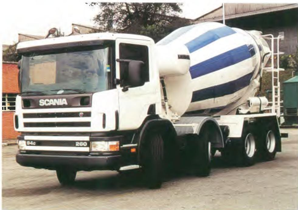
P 94 CB 8x4 NZ: indicado para betoneiras, com 260 cv e capacidade para 8 m<sup>3</sup>
