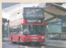
**1996** - A Scania apresenta um ônibus urbano com carroceria de alumínio, piso rebaixado e ajoelamento lateral completo – perfeitamente adaptado ao tráfego urbano. A plataforma também é utilizada para os ônibus de dois andares Scania OmniLink e Scania OmniCity.
