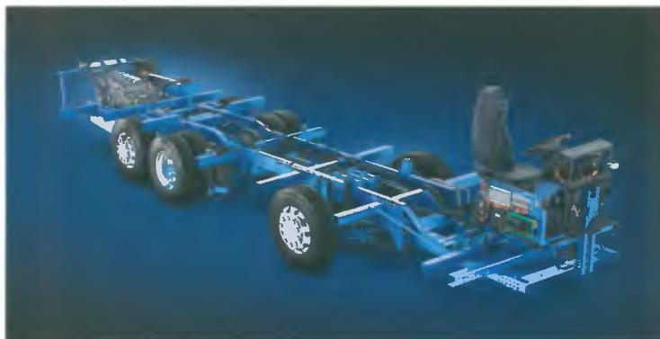
**Chassi da Série K incorpora o sistema de controle da suspensão a ar**
