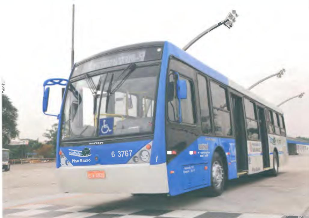
**Os ônibus são movidos a etanol especial, com 5% de aditivo para obter melhor combustão**
