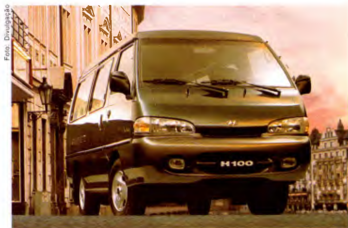
A van H100, da Hyundai: capacidade para 12 passageiros e potência de 85 cv a 4.000 rpm
