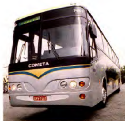
Uma das novidades do CMA Cometa é o itinerário eletrônico, localizado no alto, à esquerda
