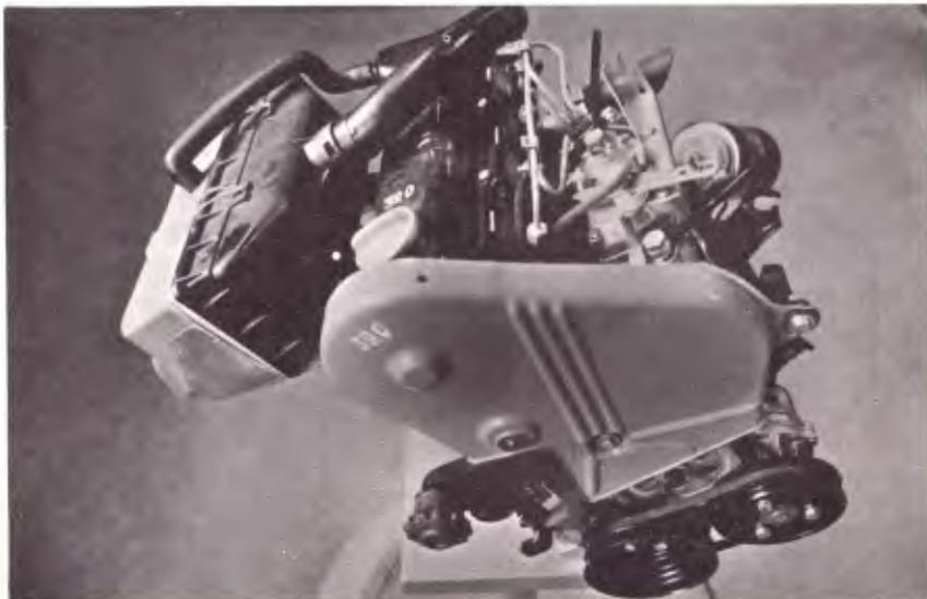
**O motor diesel da VW é basicamente o do atual Passat de 1,5 litros.**
