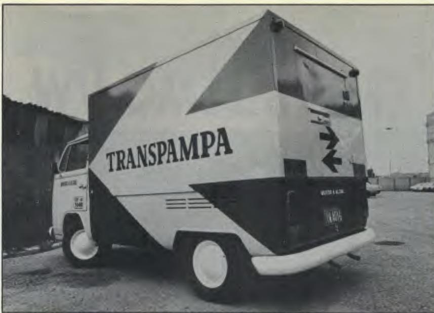
Usando dupla carburação, a primeira picape convertida estava fazendo 4,53 km/litro, com motor amaciando
