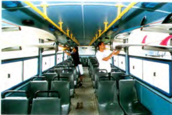
Para atender a surfistas e banhistas que se locomovem entre as praias de Guarujá, a empresa Viação Guarujá criou o Wave Bus, adaptado para a colocação de 24 pranchas de surfe em prateleiras afixadas na parte superior interna do veículo e presas por extensores (fotos), com espaço demarcado no piso para as pranchas "morey boogie".
