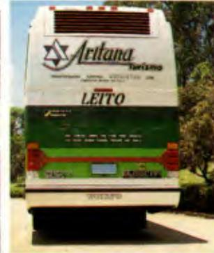
**A nova linha Busscar traz várias inovações: itinerário inferior (antes só havia o superior); porta-copos escamoteável com sistema de desarme automático; nova caixa de TV móvel para melhorar a visibilidade; todo o teto foi modernizado e foi aumentado em 50% o número de luminárias; já a traseira incorporou uma faixa refletiva e uma lanterna de freio brake-light para melhorar os níveis de segurança**
