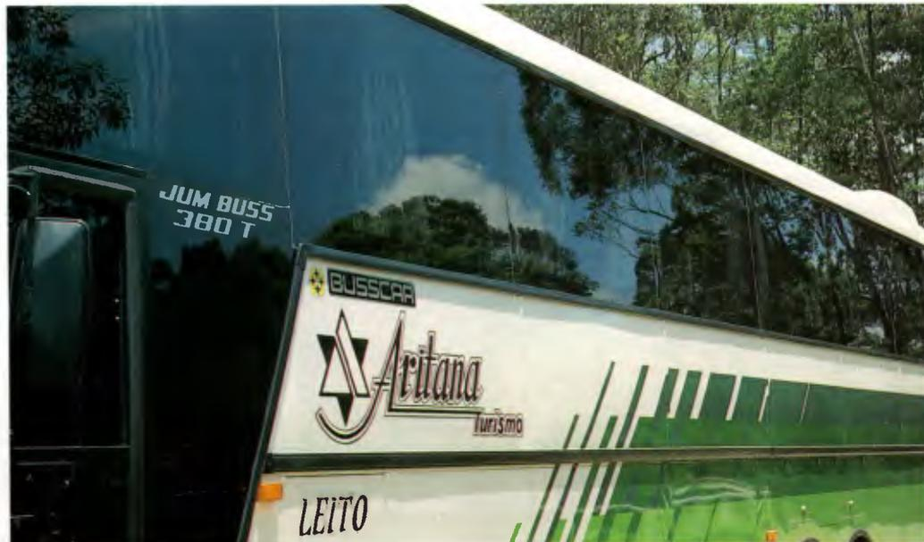
Vidros colados: janelas ampliadas e colunas reduzidas à metade
