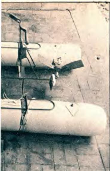
dos igarapés amazonenses, transportando palmitos produzidos na ilha de Marajó. No caso, a solução é um verdadeiro acampamento flutuante motorizado. Sobre tubos de ar de 4,5 m de comprimento, é montada uma barraca de 3,50x2 m, que conta com banheiro, instalações sanitárias, cozinha e dormitórios.
