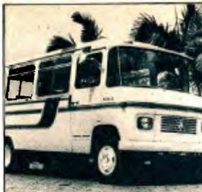
**Microônibus Marcopolo:** montado sobre chassi Mercedes L-608D, é produzido em série e tem três diferentes versões.
