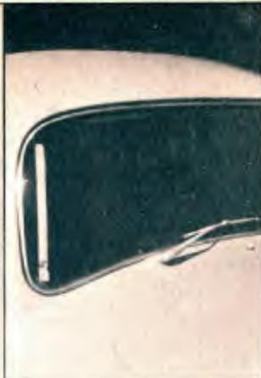
A antena agora é um fio metálico, embutido no vidro do pára-brisas.
