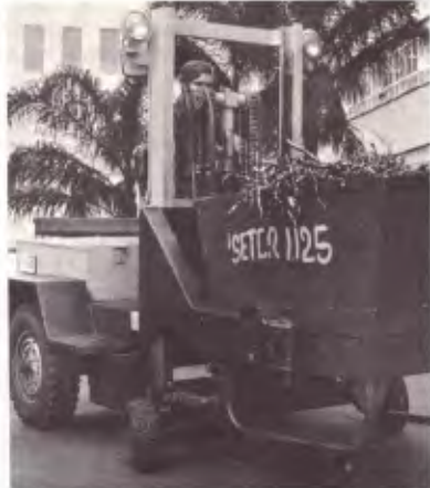
A Kombi, ao contrário, para cargas e socorros e a "Cavaqueira", empilhadeira "feita em casa", que levanta peso e transporta.
