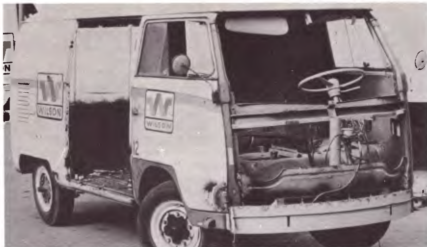
Uma reforma completa por ano, o corrosivo castigo à Kombi.
