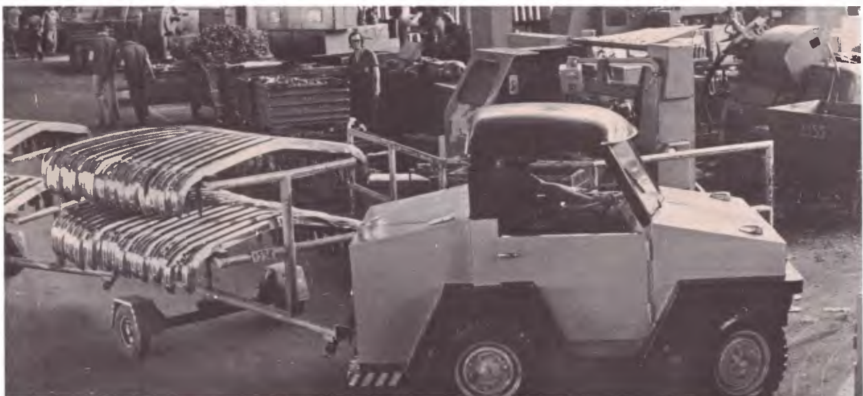
O Buggy, "feito em casa": 1,40 m de entre-eixos, por isso, muito ágil nas ruelas da produção.
