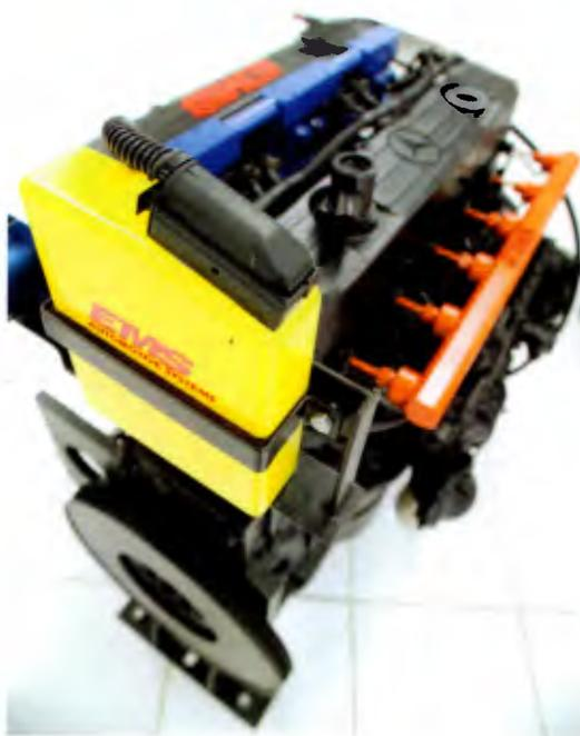
multiponto de gás de alta precisão e um controle eletrônico de diesel, no caso de motores mecânicos, todos acoplados ao motor. Segundo Sofer, o sistema não utiliza borboleta, não altera a taxa de compressão do motor, não requer troca de turbo ou comando de válvulas e tem sua instalação e remoção sem necessidade de furos, usinagem ou alterações no motor.
