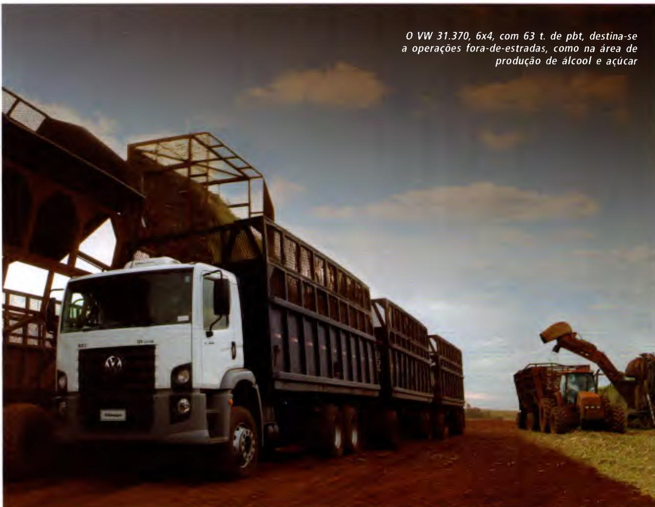
*O VW 31.370, 6x4, com 63 t. de pbt, destina-se a operações fora-de-estradas, como na área de produção de álcool e açúcar*
