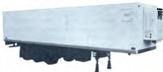
Inúmeras empresas, do Norte ao Sul do Brasil, que transportam cargas de temperatura controlada, utilizam com grandes vantagens as Carrocerias São Rafael. Totalmente construídas em plástico reforçado com fibra de vidro e espuma rígida de poliuretano, com paredes e pisos inteiriços, as Carrocerias São Rafael oferecem melhores condições de higiene, maior durabilidade (sem risco de oxidação ou ferrugem), menos peso e mais carga útil, além de alta resistência aos impactos.
