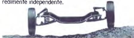
Sua suspensão, com dois braços de controle para cada roda, permite melhor distribuição do peso da carga, evitando que os choques e os trancos de uma roda se transmitam à outra.
