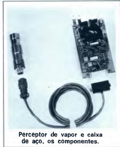
Perceptor de vapor e caixa de aço, os componentes.
