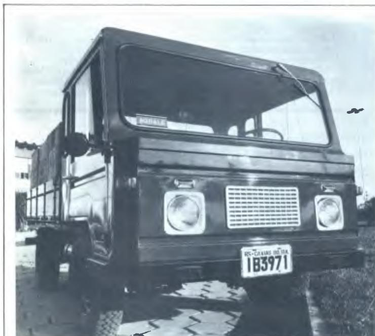
Utilizando motor diesel de dois cilindros e 36 cv, o utilitário desenvolvido pela Agrale acaba de provar, em Caxias do Sul, RS, que pode fazer até 15 km por litro de combustível.
