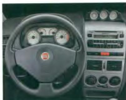
**O Locker possui quadro de instrumentos exclusivo, com bússola e inclinômetros**
