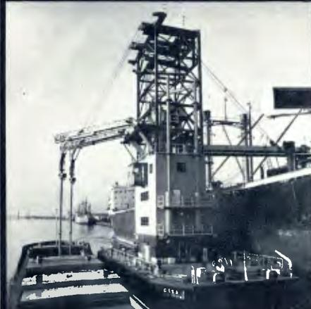
SISTEMA FLUTUANTE "CESA-1" Sugador flutuante para carga e descarga de navios, operando em Porto Alegre.
