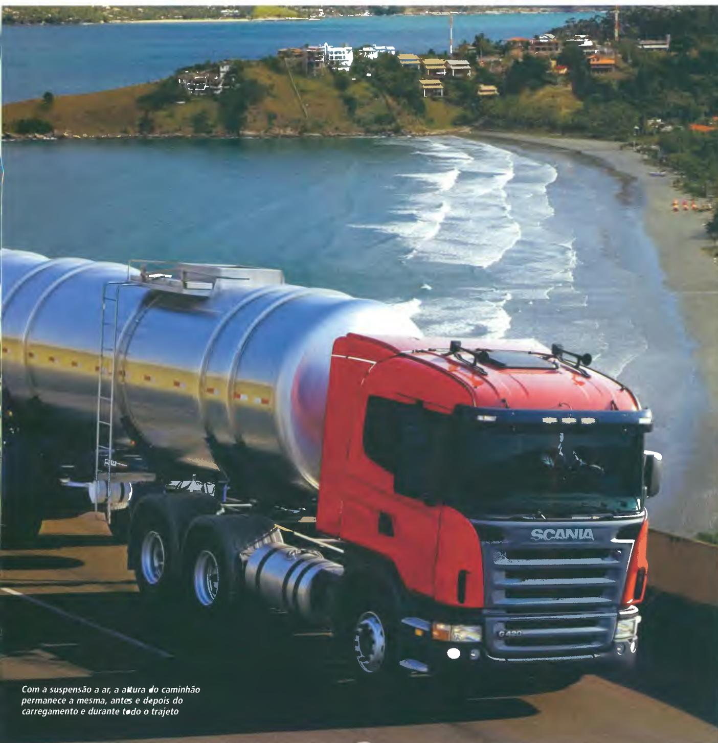
*Com a suspensão a ar, a altura do caminhão permanece a mesma, antes e depois do carregamento e durante todo o trajeto*
