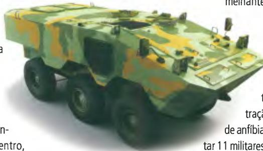
melhantes ao VBTP-MR brasileiro. O veículo será uma viatura de transporte de 18 toneladas, equipada com motor diesel eletrônico, tração 6x6 e capacidade anfíbia, capaz de transportar 11 militares.
