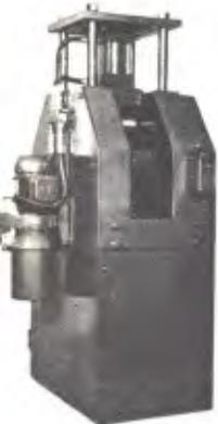
A Arqueadeira de Molas LCR, de acionamento semi-hidráulico, permite arquear a frio, de forma fácil, prática e rápida, e com total e perfeita uniformidade de arqueamento, substituindo o ultrapassado método da marreta.
