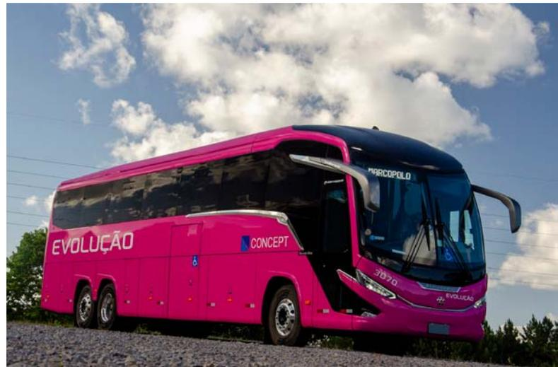
Os ônibus Paradiso G8 1200 produzidos para a Evolução possuem chassi Mercedes-Benz, modelo O 500RSD 6x2, com 14 metros de comprimento. Os veículos contam com 46 poltronas semileito, com descanso de pernas, sanitário e sistema de ar-condicionado.
