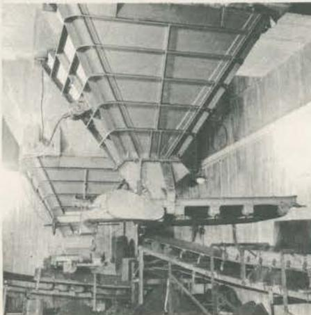
O progresso trazido pelos vibradores externos originou modificações de certos tipos de peneiras vibratórias, que puderam ter vários componentes eliminados: partes móveis, eixos excêntricos e polias desbalanceadas, correias de transmissão etc.
