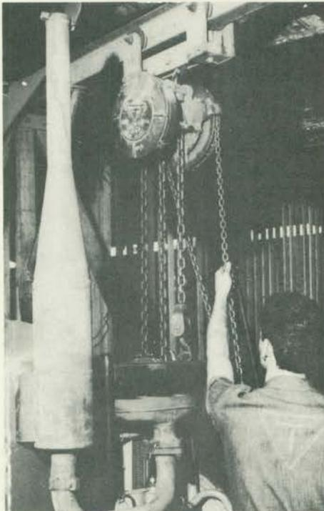
As talhas manuais que utilizam o sistema de engrenagem, ou planetário, possuem duas correntes distintas, para levantamento da carga e operação.
