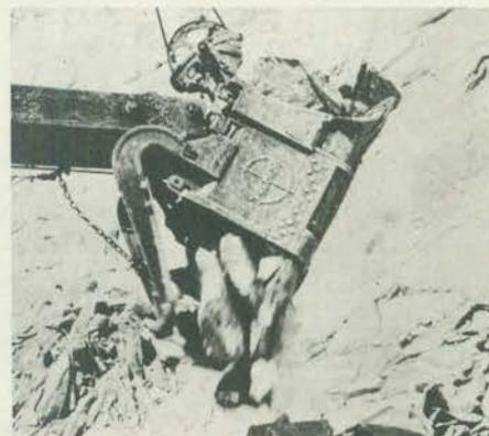
**CAÇAMBA** — Com a substituição da caçamba defeituosa é possível, na maior parte das vezes, recuperar uma escavadeira inoperante. Montados com componentes fundidos em aço, conforme projetos originais, esses implementos são fabricados no País. Adaptáveis a qualquer tipo de máquina, são fornecidos em diversas capacidades: 1/2, 3/4, 1, 1 1/4, 1 1/2, 1 3/4, 2 e 2 1/2 jd<sup>3</sup> (aproximadamente, de 0,38 a 1,92 m<sup>3</sup>). Serviço de Consulta n.º 4.
