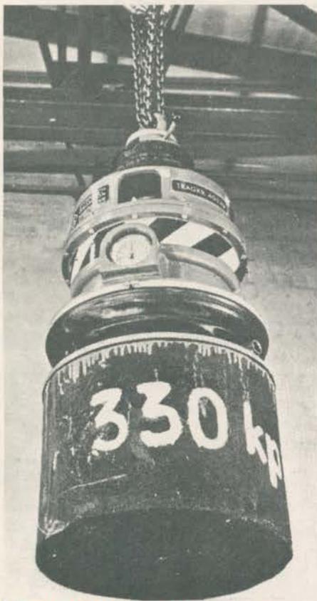
**LEVANTAMENTO A VÁCUO** — Com o emprêgo do Autovac — de funcionamento a vácuo — podem ser levantados materiais planos ou ligeiramente arredondados. Esse dispositivo, que possui a capacidade máxima de 350 kg, estabelece o vácuo graças à própria carga que levanta. Completamente independente do equipamento de levantamento, pode ser usado em áreas estritas; elimina totalmente a necessidade de ganchos e serve também como balança. Serviço de Consulta n.º 6.
