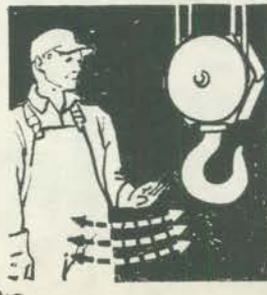
As pontes rolantes possuem comandos elétricos, que podem ser acionados da cabina ou do piso, mediante um sistema de botoneiras. São dotadas de um sistema de proteção, para garantir a segurança durante as operações; limitadores; freios eletromagnéticos etc.
