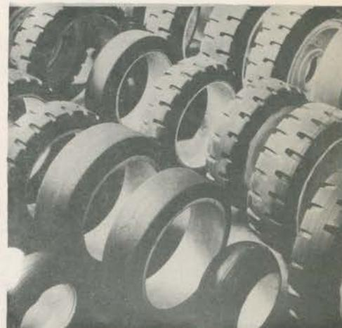
**NOVATRAÇÃO** esta capacitada para executar o revestimento de qualquer tipo de roda maciça de borracha, gasta ou avariada.
