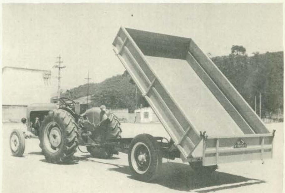
A basculação é feita mediante tomada de força no sistema hidráulico do trator.
