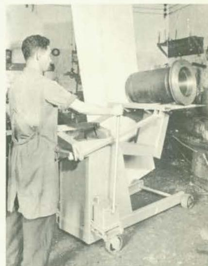
**EMPILHADEIRA** — O manuseio racional de cargas, além de proporcionar economia de mão-de-obra e tempo, diminui os riscos de acidente. Um nôvo tipo de empilhadeira, inteiramente construída de aço e acionada por bomba hidráulica de dupla ação, levanta até 500 kg em apenas dois minutos. **Serviço de Consulta n.º 6.**
