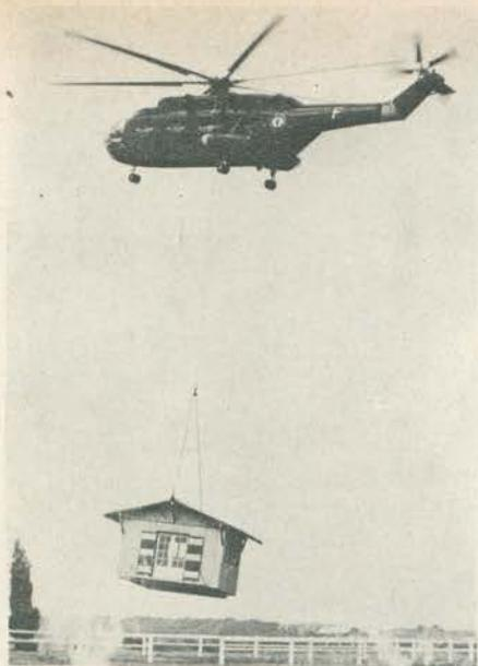
**CASA QUE VOA** — Uma casa pré-fabricada pode ser transferida de um local para outro, por via aérea, com o concurso de um helicóptero. É o que se demonstrou recentemente, quando um "Super-Frelon", fabricado pela Sud Aviation, empresa francesa, executou a mudança de uma casa diante de uma surpresa delegação de parlamentares europeus. O helicóptero em questão é capaz de carregar e depositar até 5 toneladas de carga.
