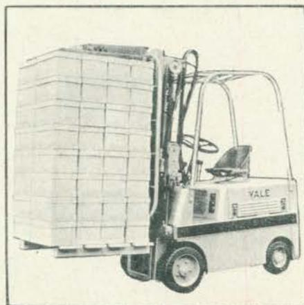
Figura 12: Estabilizador de cargas
