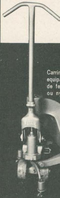
Carrinho hidráulico, equipado com rodas de ferro, borracha ou nylon.
