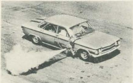
**VENTOS LATERAIS** — Um novo sistema para simular ventos laterais sobre veículos foi desenvolvido pelos laboratórios da General Motors. O sistema utiliza um motor a reação, montado sobre a parte lateral do veículo.
