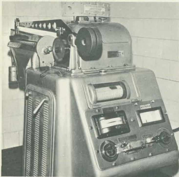
Máquinas especiais para testes de Coeficientes de Atrito, garantindo a excepcional qualidade Cobreq.
