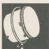
Os fochos alto e baixo do Sealed-Beam G-E permitem ao automobilista longo alcance e luz dirigida antiofuscante para a direita da estrada, na intensidade suficiente para garantir a sua segurança.
