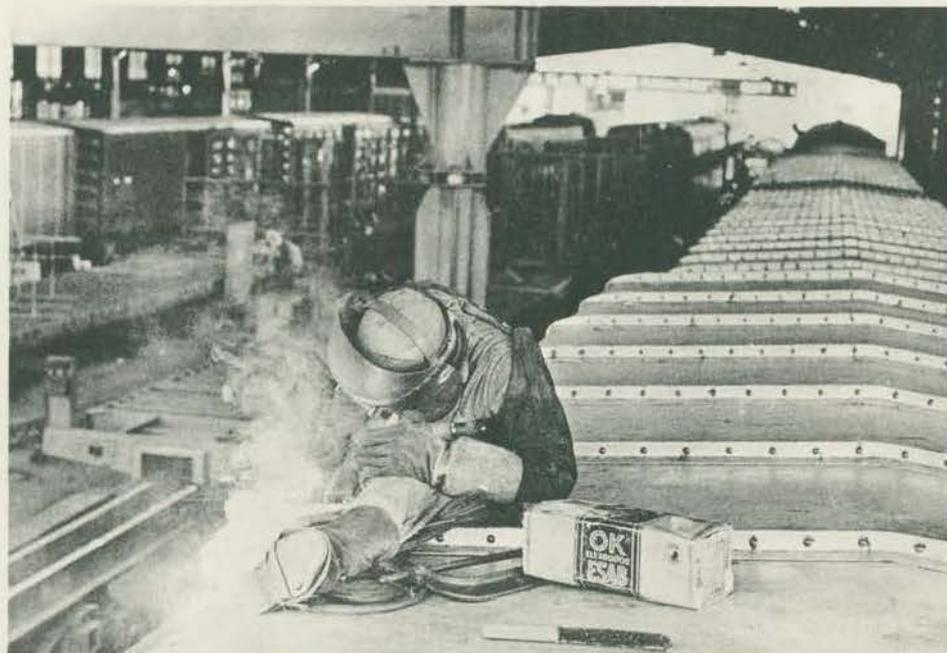
**SIMPLICIDADE** — A linha de produção de vagões é bem mais simples do que se possa imaginar. Trata-se fundamentalmente de um galpão para junção e soldagem das chapas que formam a carroceria. O conjunto é depois montado sobre truques.
