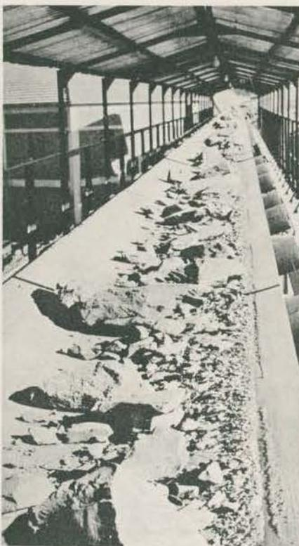
**COBERTURA PROTEGE** — Uma cobertura aplicada sôbre o transportador, além de proteger o equipamento, evita que certos materiais sofram a ação da umidade, muitas vezes danosa.
