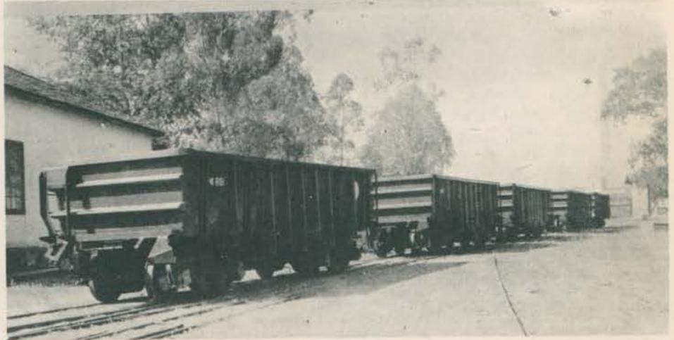
**GÔNDOLA** — A gôndola de bordas fixas é utilizada principalmente no transporte de minério. Tem capacidade para 72 toneladas e serve no sistema "Dumper-car".
