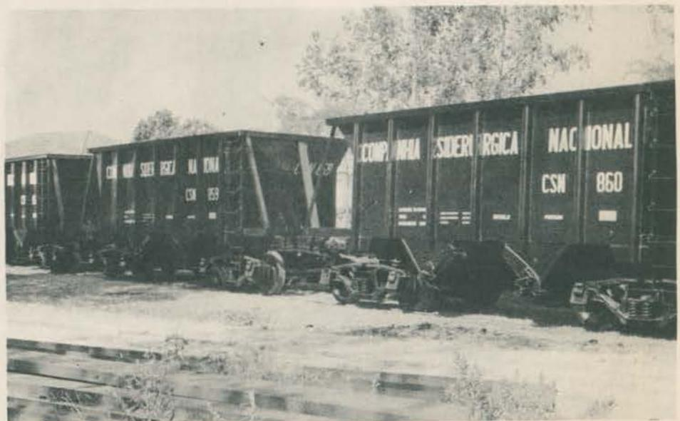
**TREMONHA** — Tipo particularmente usado no transporte de lastro pelas ferrovias. Nota-se em baixo, bôcas basculantes que deixam tombar o lastro nas linhas.
