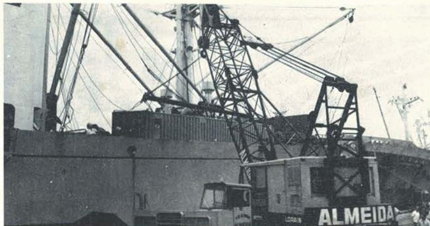
As operações de carga e descarga dos contêineres são feitas, de preferência, com o pau-de-carga da própria embarcação. No caso do equipamento de bordo não ser suficiente, em capacidade ou rapidez de operação, as docas usam guindastes sobre pneus como meio auxiliar de manuseio.
