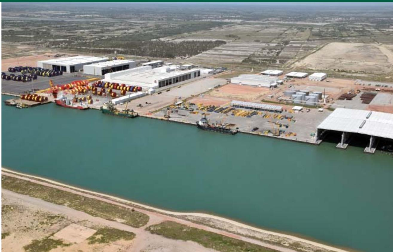
O terminal T2 no entorno de um canal para navegação tem 6,5 km de extensão, 300 m de largura e até 14,5 m de profundidade
